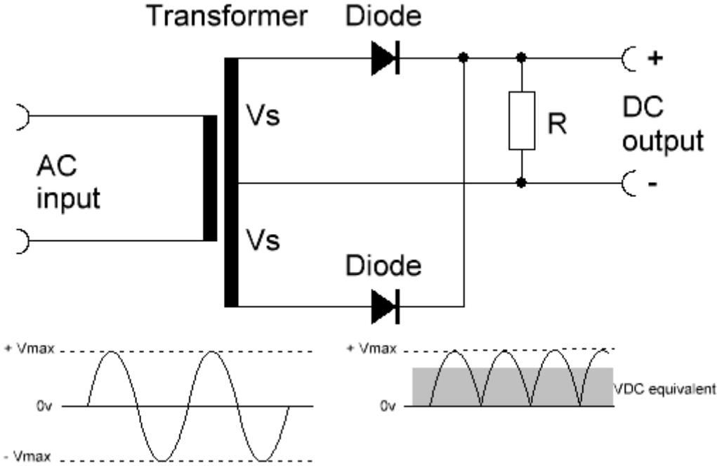
Figure 4. Full wave rectifier
