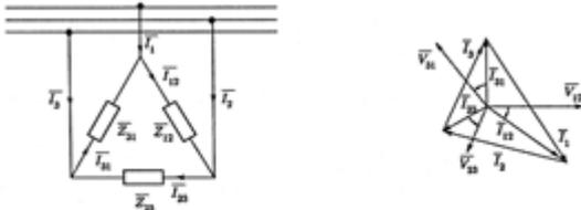
Fig. 4.23: Sistema disimmetrico e carico equilibrato.
