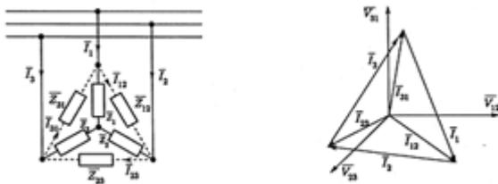
Fig. 4.24: Sistema disimmetrico con carico non regolare collegato a stella.
