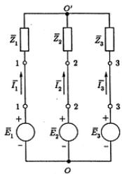
Fig. 4.19: Carico irregolare in collegamento stella-spuria.
