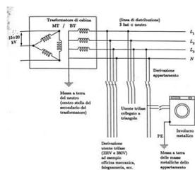
*Carichi irregolari con sistema trifase squilibrato nella corrente, ma simmetrico nella tensioni (supponendo trascurabili le cadute di tensione sulle fasi del generatore)*
