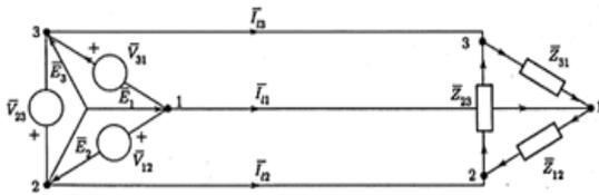
Fig. 4.8: Sistema simmetrico di tensioni collegato a triangolo con un carico regolare pure esso collegato a triangolo.
