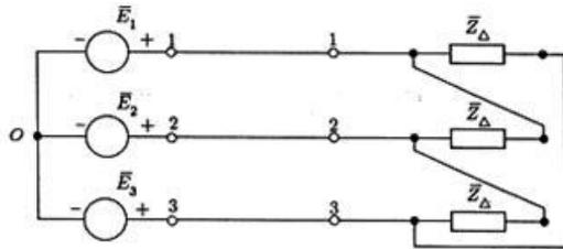
Fig. 4.10: Fasi del generatore collegate a stella e carico collegato a triangolo.
