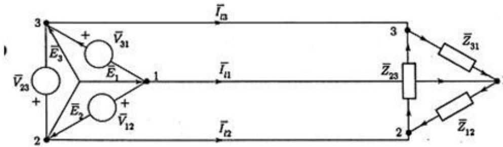
Fig. 4.8: Sistema simmetrico di tensioni collegato a triangolo con un carico regolare pure esso collegato a triangolo.
