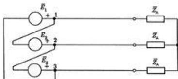
Fig. 4.12: Fasi del generatore collegate a triangolo e carico collegato a stella.
