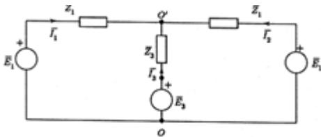
Fig. 4.21: Analisi di carico irregolare collegato a stella.
