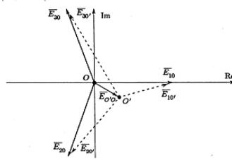
Fig. 4.20: Diagramma fasoriale nel caso di carico in configurazione stella spuria.
